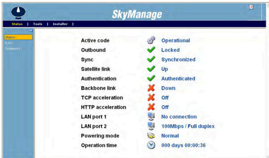
Figura 27: VSAT autenticado com sincronização e link de satélite ativo
